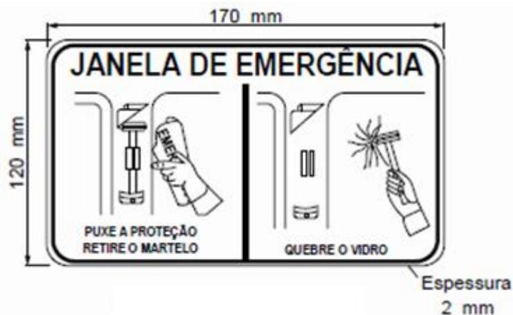
Figura 4 – Modelo do adesivo para instrução de utilização do dispositivo de destruição
