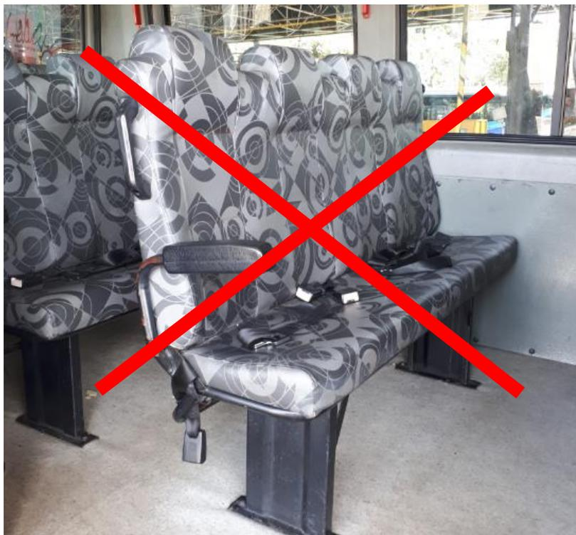
Bancos com assentos e encostos individualizados, estofados, com protetor de cabeça, parte traseira totalmente fechada, apoio de braço no corredor, pega-mão incorporado e cinto de segurança de 3 pontos
