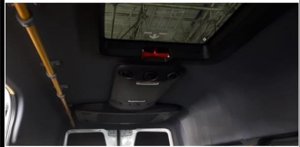
Veículo equipado originalmente com saída de emergência no teto deve dispor de identificação e instrução de uso
