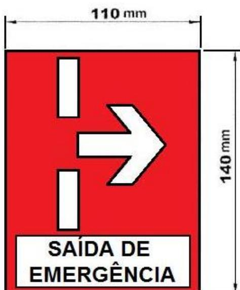
Figura 2 – Modelo de adesivo indicativo da saída de emergência
